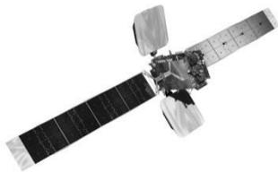
Satellite di tipologia MEO (Medium Earth Orbit) solitamente impiegato per effettuare mappature tramite un sistema radar ad apertura sintetica in grado di penetrare la crosta terrestre. Si differenziano dai semplici satelliti spia perché sfruttano frequenze a banda KU ed a banda KA per comunicare con i centri di comando terrestri.
