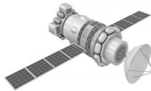
Satellite ad utilizzo civile di tipologia LEO (Low Earth Orbit) solitamente impiegato per le reti per comunicazioni satellitari con i sistemi aeronautici, navali e terrestri. Il Sistema MOUS sfrutta 4 satelliti e riesce a coprire una vasta superficie terrestre. Purtroppo utilizzando le Ultra High Frequency (banda P e banda L) non può permettersi di allontanarsi troppo dalla atmosfera terrestre.
